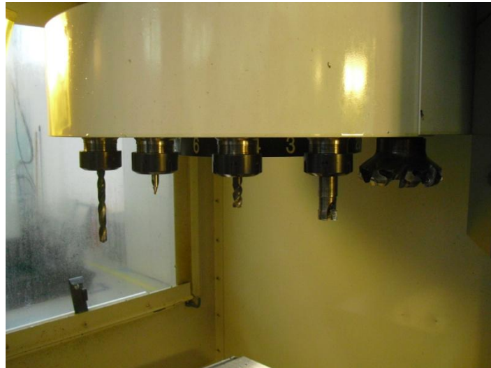
Figura 1- Torreta com as ferramentas montadas.
